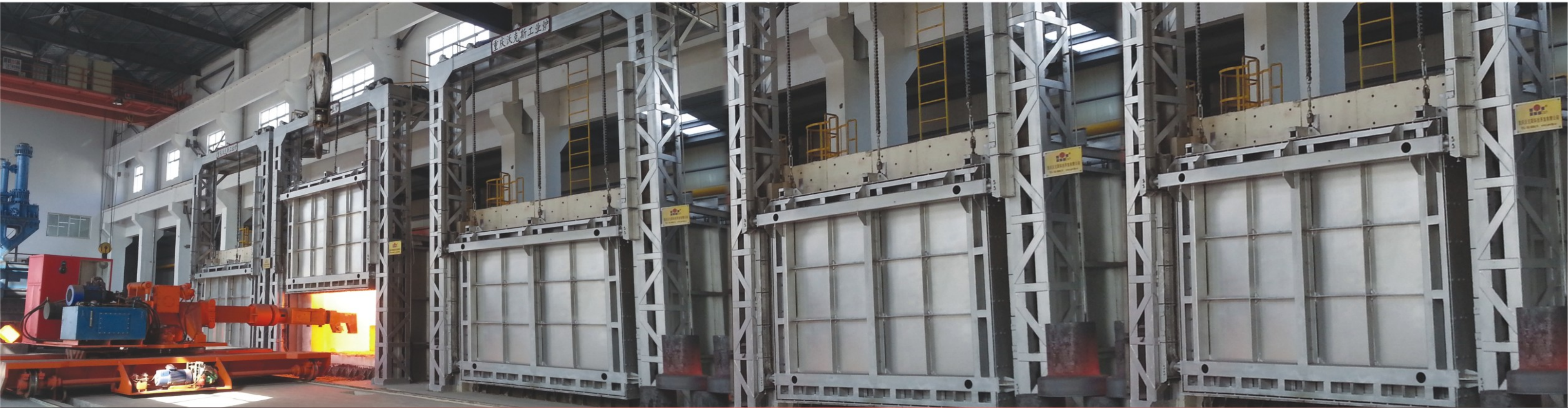
用于特殊材料锻造的蓄热式高精度锻造加热炉
